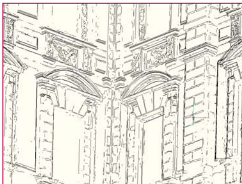
Figura 4 – Esempio terrestre: filtratura delle linee di discontinuità con il modello LiDAR e selezione delle linee di discontinuità geometrica (break-line).
