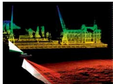
**Rilievi 3D terrestri, marini, sotto costa:** MultiBeam, SubBottom profiler e laser scanner integrati per operazioni di primo soccorso, monitoraggio dei fondali e delle coste. Studio del dissesto idrogeologico, geognostica preliminare...
