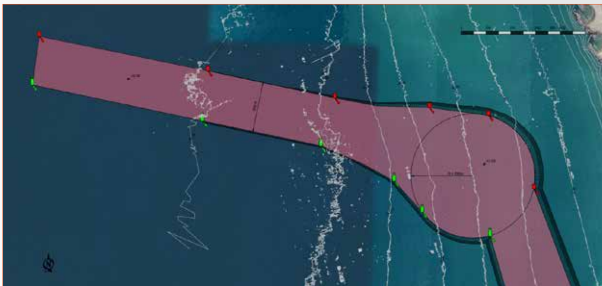
Fig. 6 - Canale di accesso al porto. Sono previsti circa 2 milioni di mc di dragaggio per garantire l'avvicinamento delle navi alla costa ed al porto [Tavola OM51 di progetto "2 planimetria di dragaggio"].
