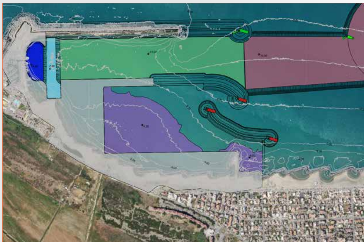
Fig. 5 - Progetto del porto di Isola Sacra. Circa 1 milione di mc di dragaggio all'interno del porto per raggiungere la profondità di -11,50 m [Tavola OM51 di progetto "1 planimetria di dragaggio"]
