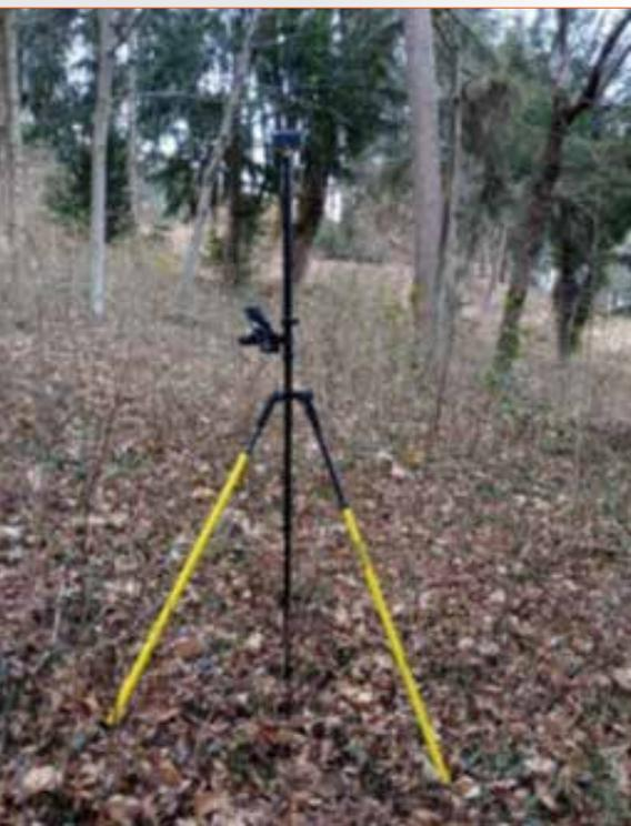
Fig. 4 - Ricevitore GNSS Solutop MS2 in stazione su palina e bipiede, con smartphone per la gestione del rilievo (da Mattioli et al., 2025).
