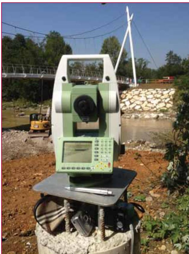
Figura 4 - Il teodolite su pilastro stabile.
