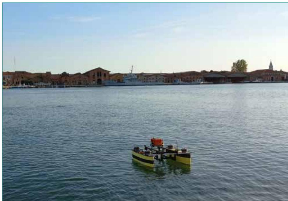
Fig. 1 – Il veicolo robotico di superficie SWAMP (Shallow Water Autonomous Multipurpose Platform) sviluppato dal CNR INM, sede di Genova.
