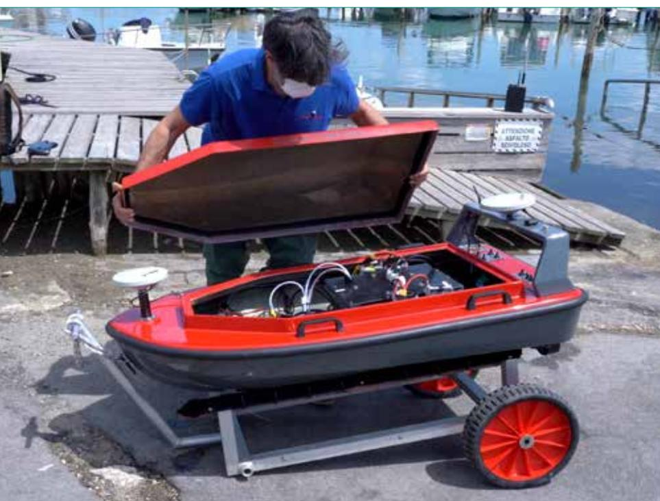
Fig 5 – Accesso alla strumentazione e alle batterie.
