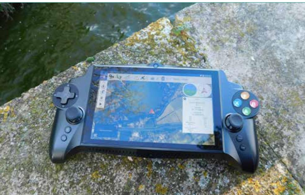
Fig. 4 – La console per il controllo e la gestione del drone e della strumentazione di bordo tramite Wi-Fi.
