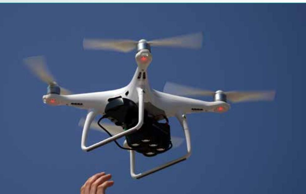
Fig. 1 – Sensore Sentera 6X integrato a bordo di drone Phantom4 in volo (foto archivio Aviocam).
