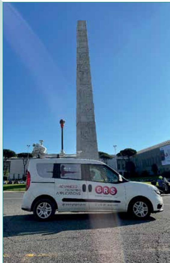
Fig. 1 – Sistema Laserscanner Mobile Riegl VMQ-1HA montato su veicolo.
