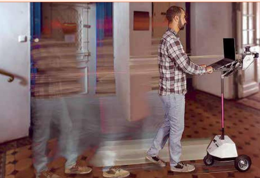
Fig. 1 - Il dispositivo di registrazione di VOXEL-GRID può acquisire fino a 10.000 metri quadrati di superficie in un giorno.
