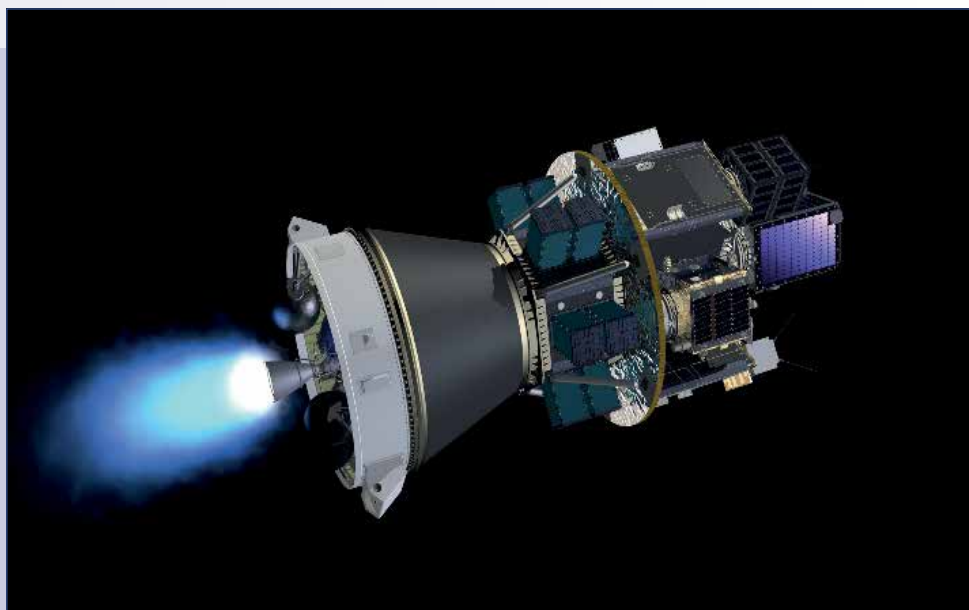
Fig. 3 – Il “dispenser” SSMS sul quarto stadio di Vega.
