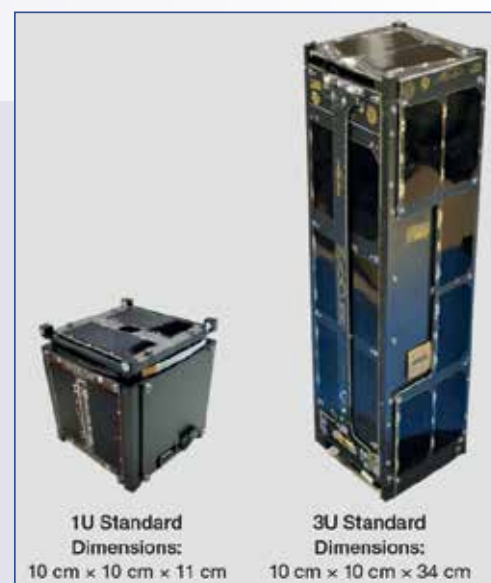
Fig. 5 - Modularità dello standard Cubesat.
