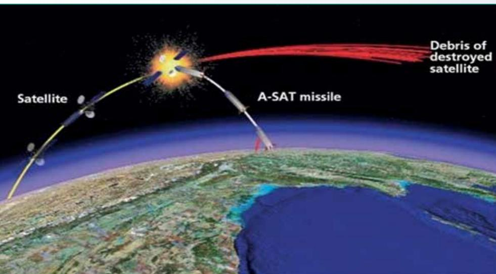
Fig. 5 - Dinamica di un attacco anti-satellite di tipo "cinetico".
