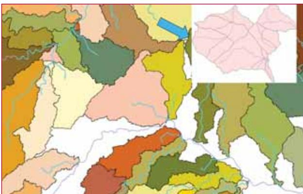
Figura 5 – Esempio di estrazione dei sottobacini idrici attraverso il DSM a 2m, con caratterizzazione e classificazione morfometrica.
