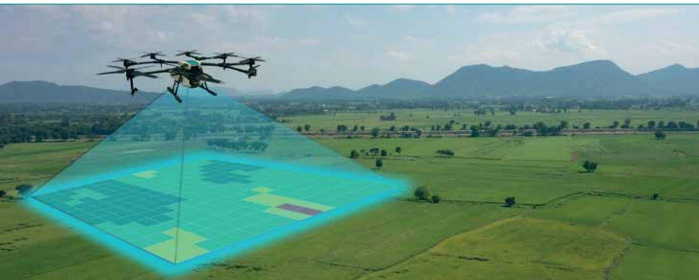
to più contenuti rispetto ad un aeromobile con pilota a bordo, pur essendo comunque necessario un operatore qualificato a terra. I droni possono realizzare rilievi fotografici, ma i modelli più grandi possono portare a bordo anche un laser scanner, grazie alla sua progressiva miniaturizzazione di cui abbiamo parlato.
