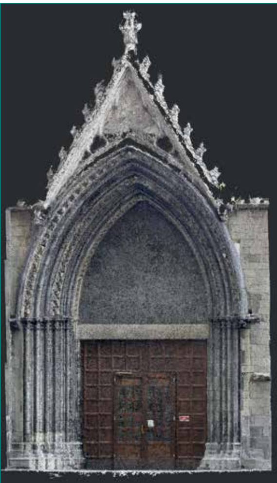
Fig. 7 - Nuvola di punti da fotomodellazione.
