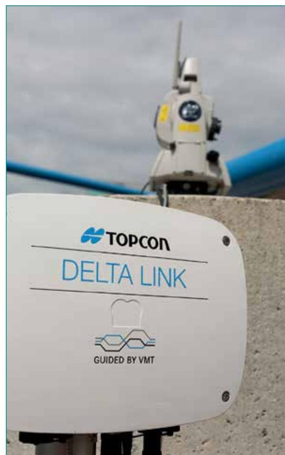
Il Delta Log è provvisto di funzionalità avanzate che consentono di gestire le letture, i tipi di target e la programmazione dell'attività dello strumento senza dover essere sul posto.
