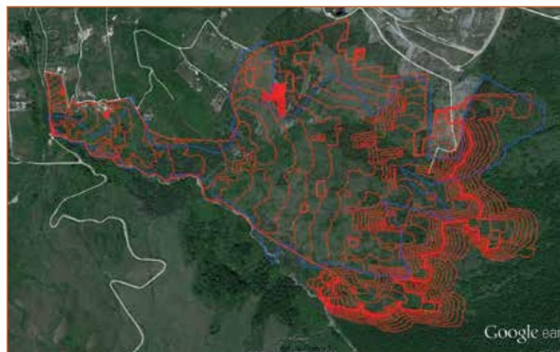
Fig. 18 - Simulazione della propagazione del fuoco (in rosso) con previsione di interventi di spegnimento da terra (freccie bianche). Il perimetro reale dell'incendio è in blu
