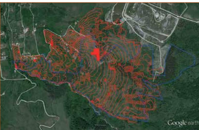
Fig. 17 - Simulazione della propagazione del fuoco (in rosso) senza previsione di interventi di spegnimento. Il perimetro reale dell'incendio è in blu.
