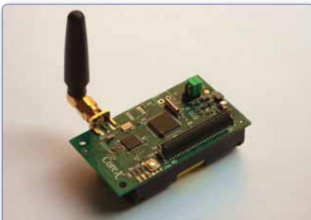
Un nodo autoalimentato (mote) di una Wireless Sensor Network.
