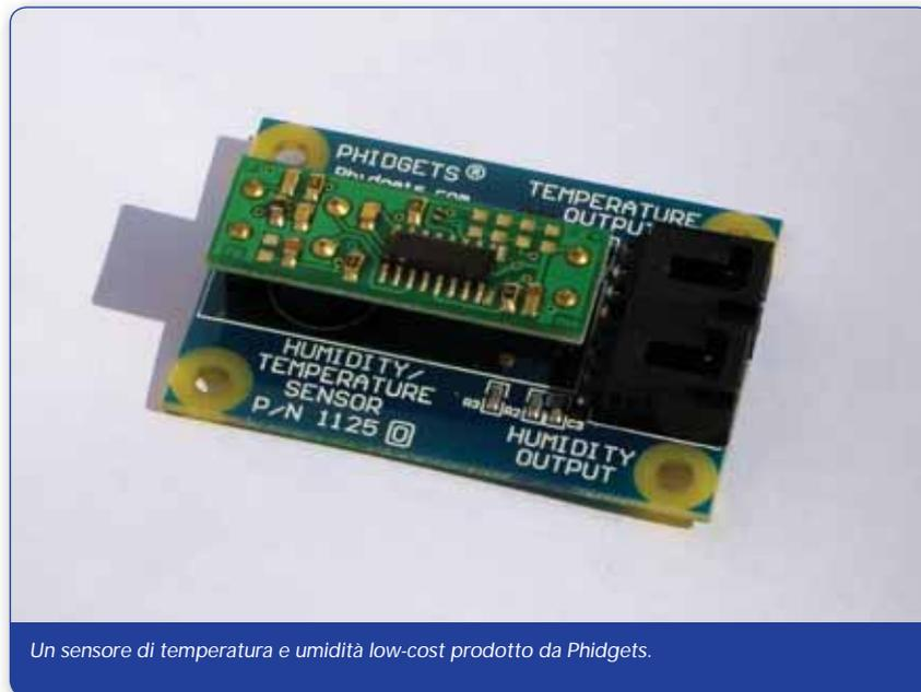
Un sensore di temperatura e umidità low-cost prodotto da Phidgets.
