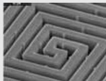
Sensore inclinometrico di tipo MEMS (fonte MEMX.com)
