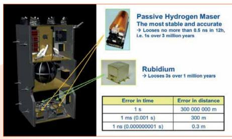
Fig. 3 - Passive Hydrogen Masers di Galileo
