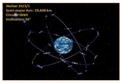
Fig. 4 - Distribuzione orbitale della costellazione Galileo
