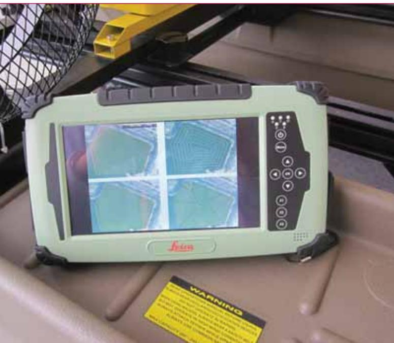
*Pianificazione di missione e controllo del sistema, con display interattivo installabile su qualunque PC (nel caso in esempio palmare Leica).*
