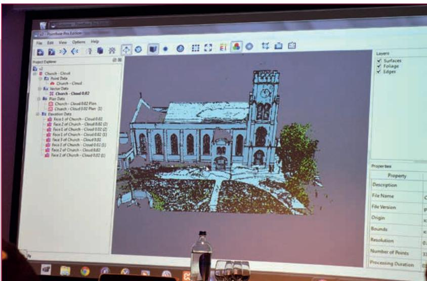
PointFuse il software che ricrea piani e linee architettoniche direttamente dalle nuvole di punti.
