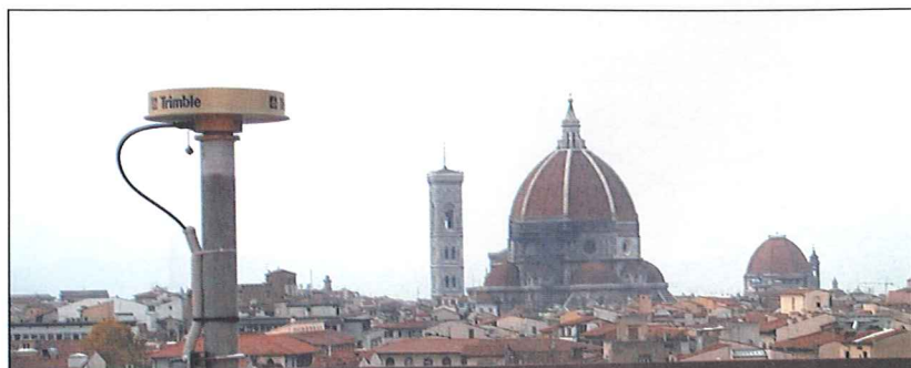
Fig. 3 - Antenna choke ring della stazione GPS TIM di Firenze
