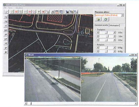
**DAVIDE** (Data Acquisition Vehicle With Inertial and Dgps Equipment)- Il sistema DAVIDE è un laboratorio cartografico mobile in grado di associare la capacità di una costante e precisa localizzazione alla possibilità di memorizzare, e quindi georeferire, i dati e le immagini
