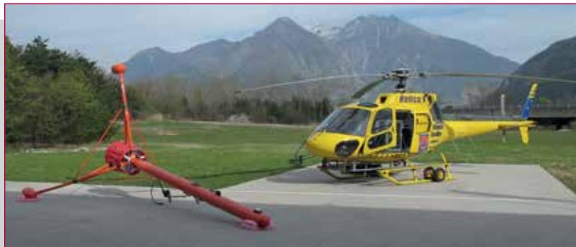
Fig. 4 – Uno degli elicotteri utilizzati per il rilievo: in primo piano il magnetometro.
