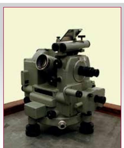
Fig. 2 - Il teodolite astronomico Gigas-Askania.
